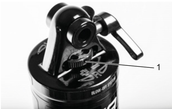
Illustration 214 : Molette de réglage de la détente Suntour (1) sur l'amortisseur arrière
