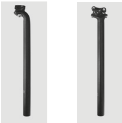
Illustration 23 : Exemple d'une tige de selle brevetée ergotec avec une ou deux vis de serrage de la selle sur la tête
