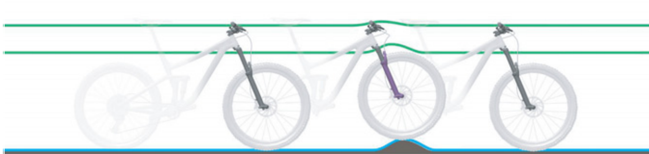
Illustration 119 : Comportement optimal sur les irrégularités
