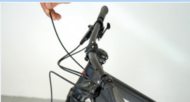
Illustration 200 : Accrocher le capuchon d'extrémité
