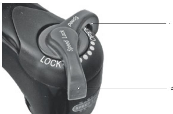
Illustration 210 : Régler le dispositif de réglage de la compression sur un niveau plus souple
