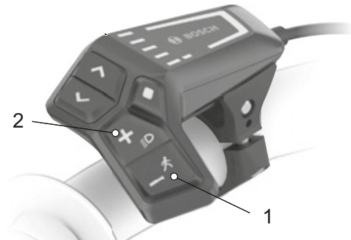
Illustration 115 : Position des touches Plus et Moins
