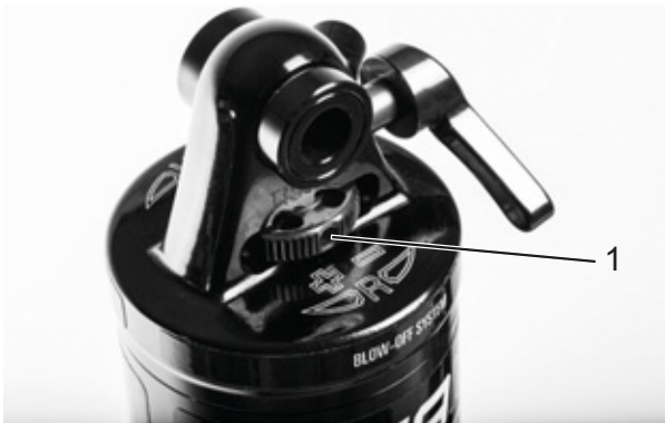
Illustration 212 : Molette de réglage de la détente Suntour (1) sur l'amortisseur arrière
