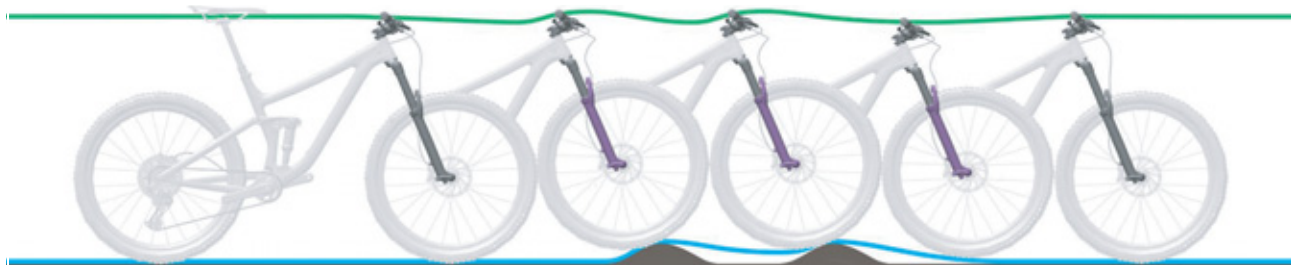
Illustration 205 : Détente trop lente de la fourche suspendue
