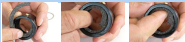
Illustration 189 : Insérer l'anneau de feutre
