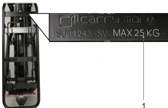
Illustration 106 : La capacité de charge maximale (1) est indiquée sur le porte-bagages.
