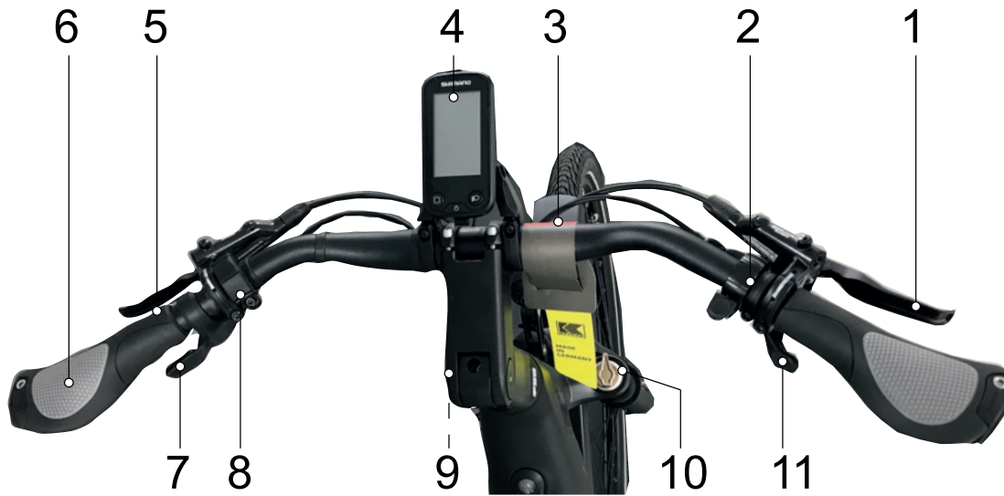
Abbildung 28: Detailansicht Lenker mit SHIMANO SC-E5003 Bordcomputer, Beispiel
