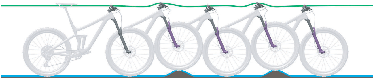
Abbildung 88: Optimales Fahrverhalten der Gabel
