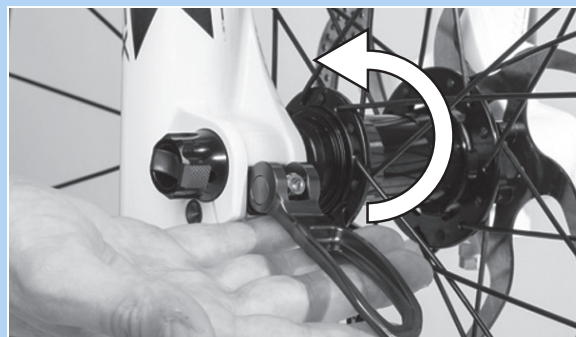
Abbildung 49: Schnellspannhebel in Pfeilrichtung drücken
