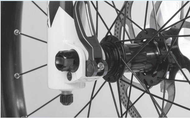
Abbildung 50: Perfekte Lage des Spannhebels
