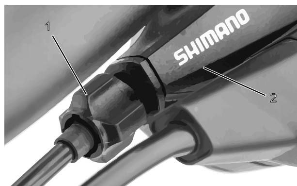
Abbildung 133: Einstellhülse (1) der einzügigen, seilzugbetätigten Gangschaltung mit Schalthebelgehäuse (2), Beispiel
