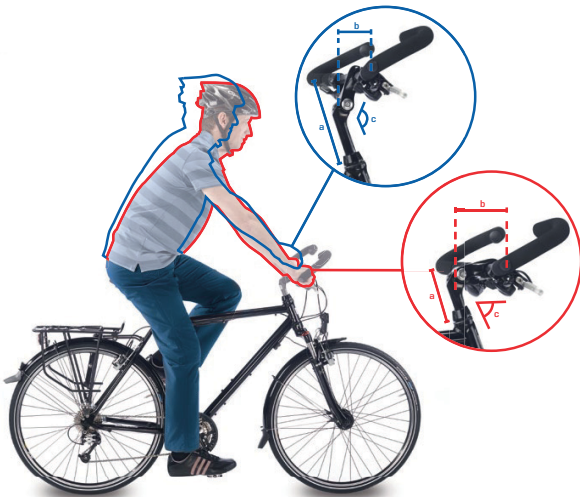
Abbildung 77: Citybike (blau) und Trekkingrad Position (rot) durch Winkeländerung
