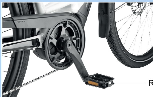
Abbildung 58: R-Pedal im rechten Kurbelarm
