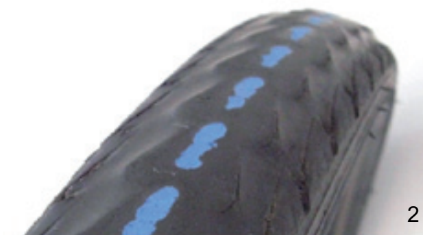
Abbildung 126: Reifen ohne Profil, der noch gefahren werden kann (1), und Reifen mit durchscheinendem Pannenschutz (2), der gewechselt werden muss
