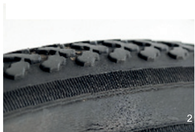
Abbildung 127: Beispiele für Ermüdungsrisse (1) und Alterungsrisse (2)
