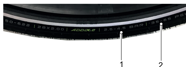
Abbildung 125: Fülldruck in bar (1) und psi (2)
