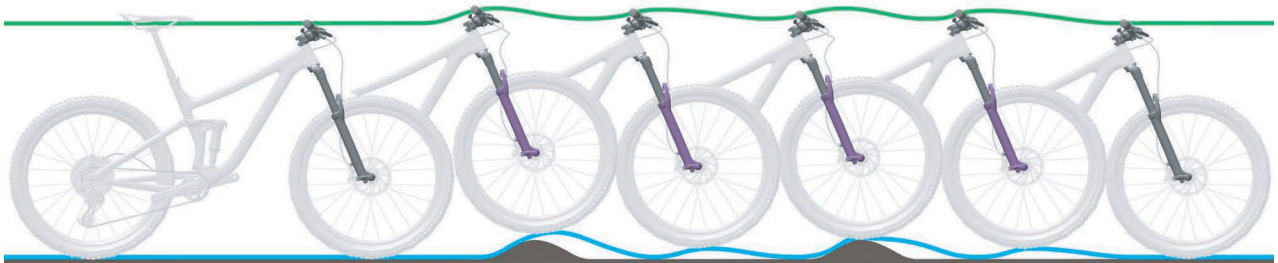
Abbildung 201: Zu schnelles Ausfedern der Federgabel
