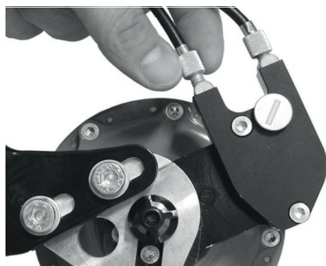
Abbildung 132: ROHLOFF-Naben Versionen mit externer Schaltansteuerung haben die Zugeinsteller an der Seilbox, die sich auf der linken Seite befindet
