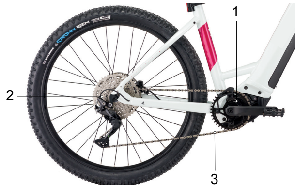
Abbildung 23: Schema Kettenantrieb mit Kettenschaltung
