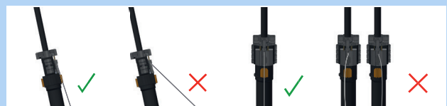
Abbildung 166: Korrekter und falscher Bowdenzug
