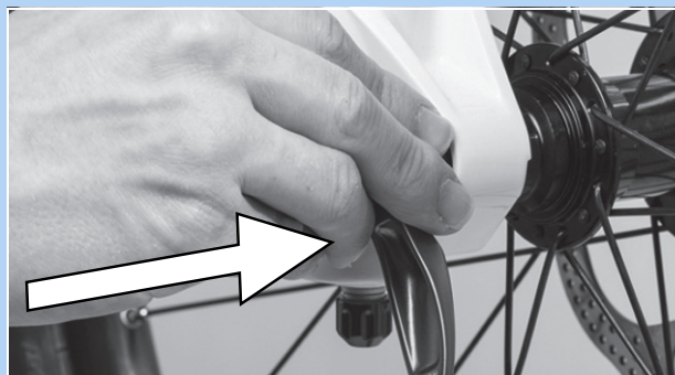
Abbildung 53: Schnellspanner in Pfeilrichtung einschieben
