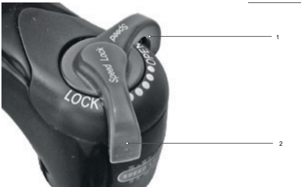
Abbildung 208: Druckstufeneinsteller weicher einstellen
