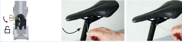
Abbildung 139: Höhenverstellungsbetätigung in „Geöffnete Stellung“ bringen
