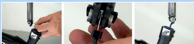
Abbildung 197: Sattelstütze aufhängen und einschieben
