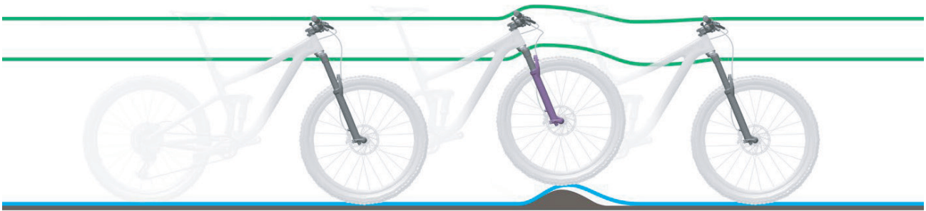
Abbildung 207: Zu harte Dämpfung der Federgabel bei Unebenheiten
