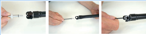
Abbildung 158: Kartusche Ventildeckel befestigen
