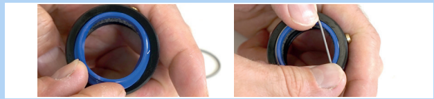
Abbildung 188: Abstreifer einlege und befestigen
