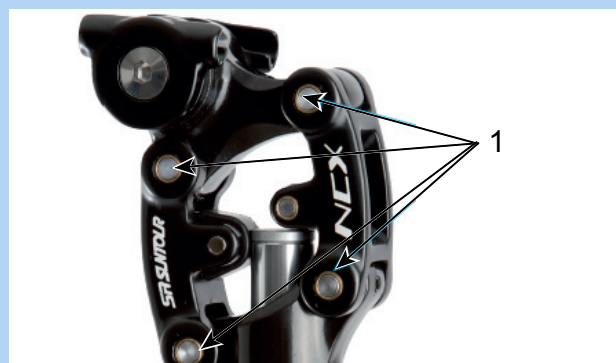
Abbildung 138: Schmierpunkte SR Suntour Feder-Sattelstütze
