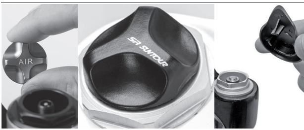
Abbildung 87: Schraubabdeckungen in unterschiedlichen Ausführungen
