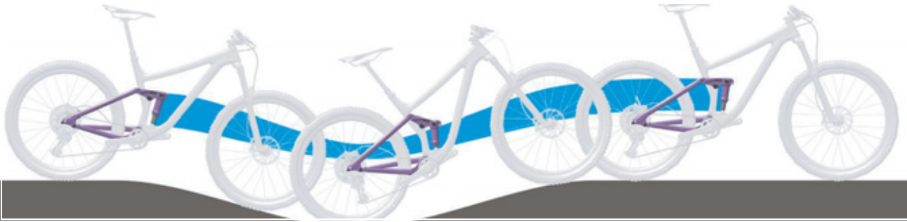
Afbeelding 140: Te zachte vering van de achterbouwdemper bij kuilen
