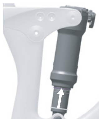
Afbeelding 84: O-ring op de achterbouwdemper verschuiven
