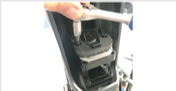
Afbeelding 35: Schroeven accuhouder losdraaien
