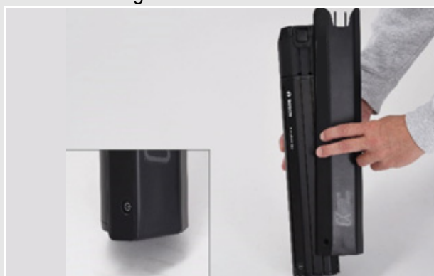
Afbeelding 47: Accuafdekking op de accu schuiven
