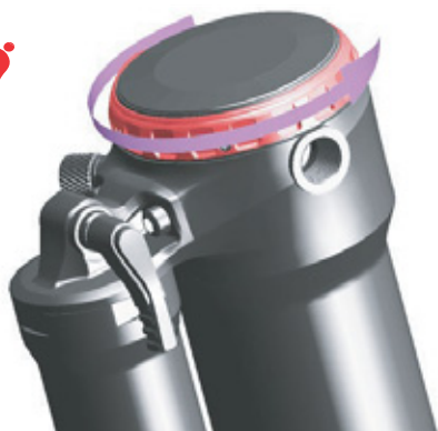
Afbeelding 139: Draai de trekdemperafsteller in de richting van de haas
