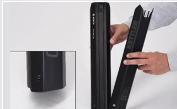
Afbeelding 43: Accuafdekking op de accu schuiven
