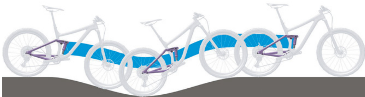
Afbeelding 92: Optimaal rijgedrag van de achterbouwdeemper in heuvelachtig terrein
