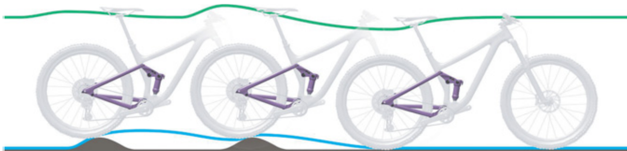
Afbeelding 138: Te langzaam uitveren van de achterbouwdemper
