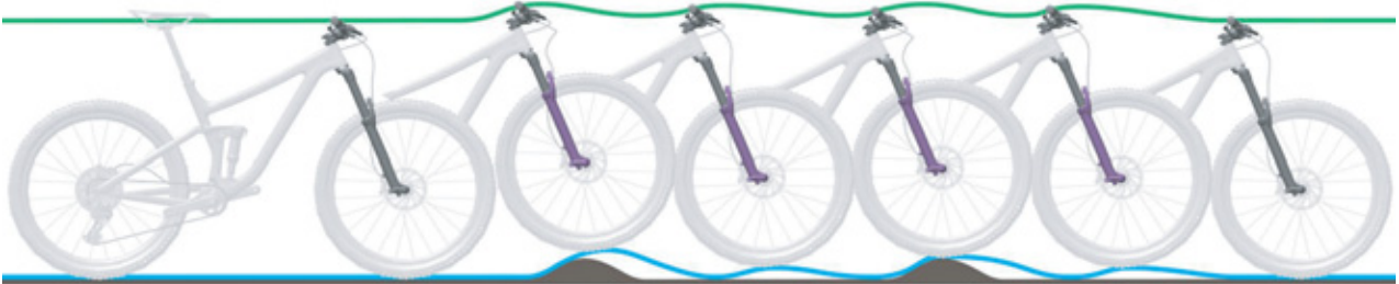
Afbeelding 128: Te snel uitveren van de verende voorvork
