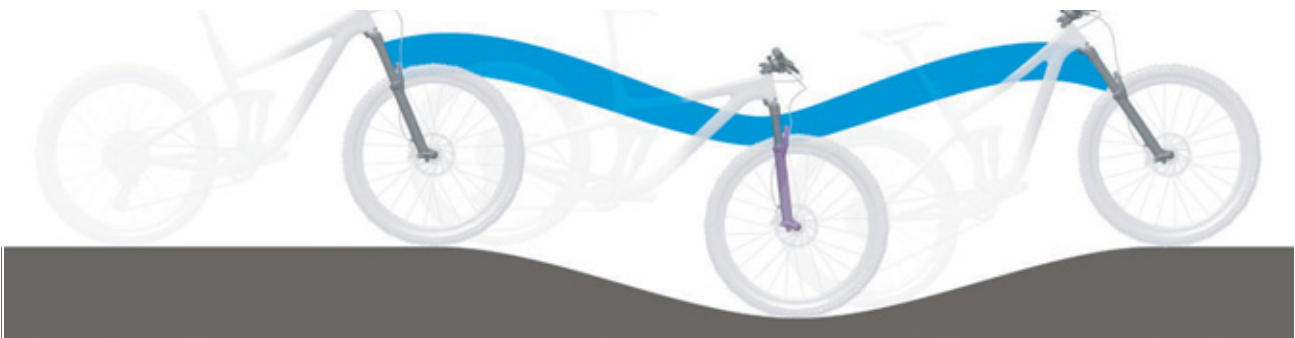
Afbeelding 6: Optimaal rijgedrag van de vork in heuvelachtig terrein
