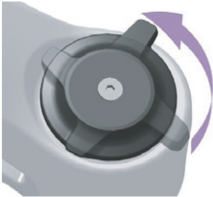
Afbeelding 135: Drukdemperafsteller zachter afstellen
