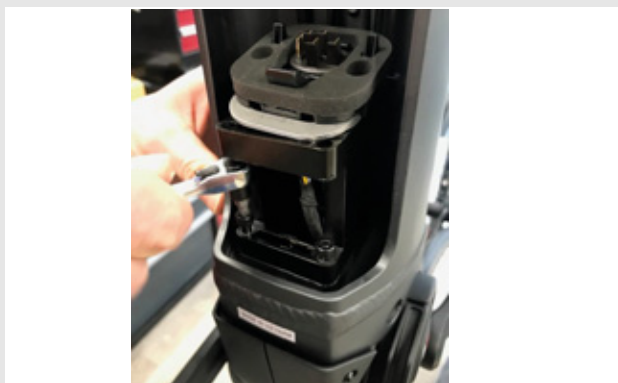
Afbeelding 36: 4 mm zeskantschroeven verwijderen
