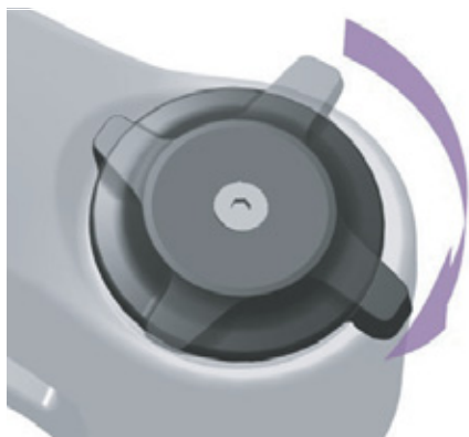
Afbeelding 133: Drukdemperafsteller harder afstellen
