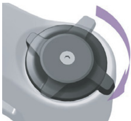
Afbeelding 117: Drukdemperafsteller harder afstellen
