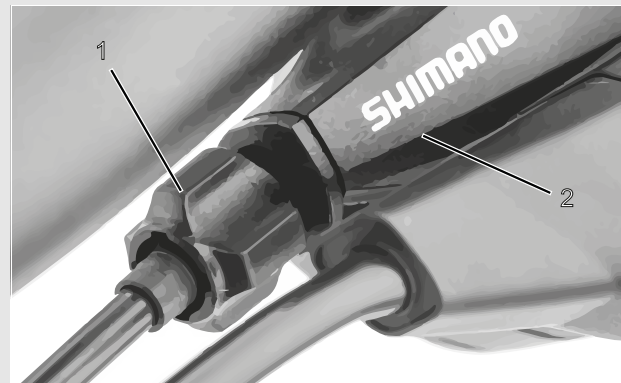
Afbeelding 125: Afstelwartel (1) van de versnelling met enkele bowdenkabelbediening en behuizing van de schakelhendel (2), voorbeeld
