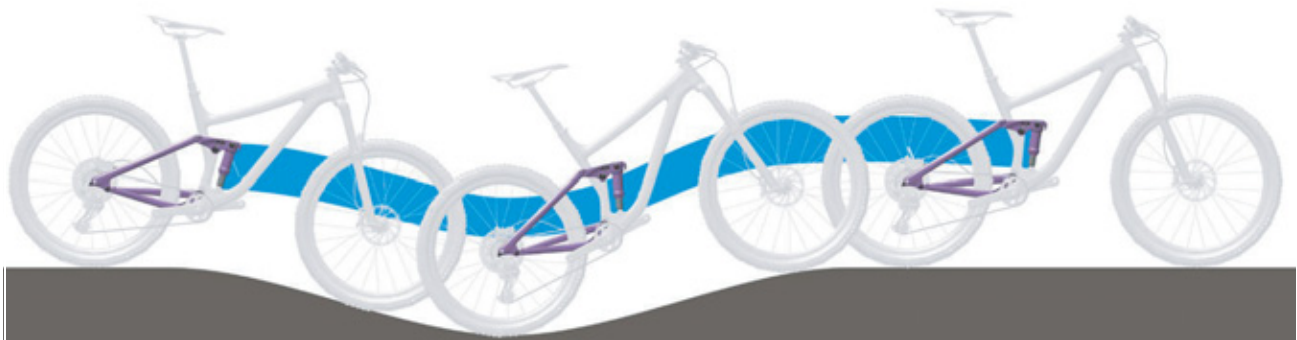
Afbeelding 11: Optimaal rijgedrag van de achterbouwdemper in heuvelachtig terrein
