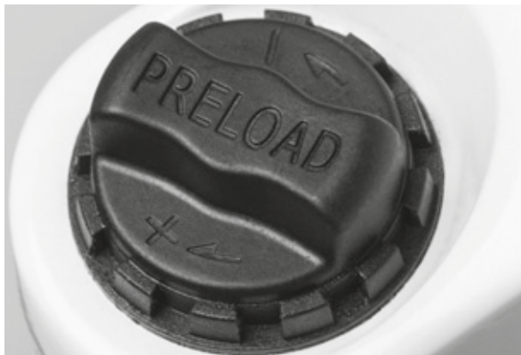
Afbeelding 77: Afstelwiel voor de sag op de kroon van de verende voorvork
