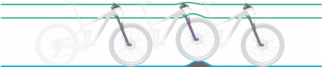
Afbeelding 7: Optimaal rijgedrag van de vork bij oneffenheden
