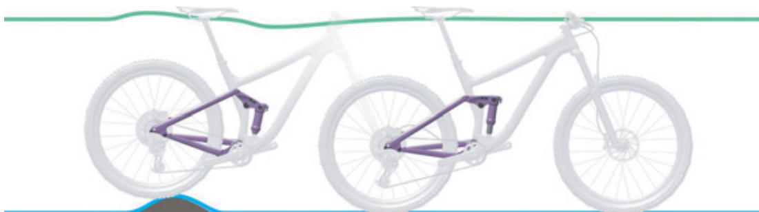
Afbeelding 12: Optimaal rijgedrag van de achterbouwdemper bij oneffenheden
