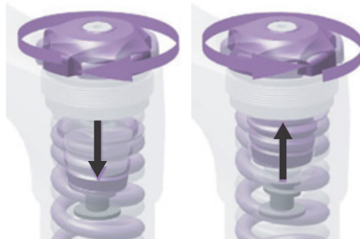
Afbeelding 79: Voorspanningsafstelling in- en uitdraaien.
